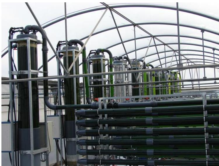
**Figura 9.** Imagen del sistema de cultivo utilizado para la estimación económica de costes. Planta semi-industrial de producción de microalgas en fotobiorreactores tubulares ubicada en la Estación Experimental Las Palmerillas de la Fundación Cajamar.
